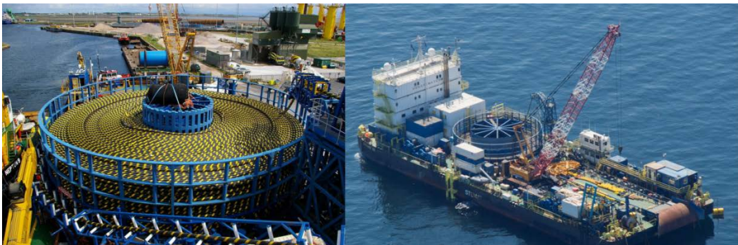
Figure 6 : Barge équipée d'un carrousel (source DONG Energy)
